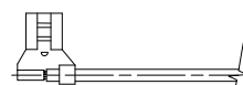
6,3x0,8 o 4,8x0,8 Faston femmina a bandiera 6.3x0.8 or 4.8x0.8 Female flag rolled receptacle
